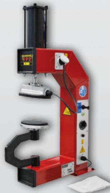
**COLONNA DI SUPPORTO:** Prevista per sostenere tutti i modelli di vulcanizzatrici (esclusa VP6) e per gli utilizzatori che non hanno spazio sul banco di lavoro. Disponibile a richiesta cod. 805420833. **SUPPORT POST:** To support all vulcanizer models (with the exception of VP6) and for use when there is no available space on the work bench. Available on request code W805420833.
