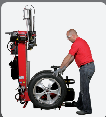
Sollevatore ergonomico consente di posizionare in maniera facile tutte le ruote sull'autocentrante (accessorio a richiesta) Ergonomic wheel lift allows easy positioning of all wheels on the turntable (optional accessory)
